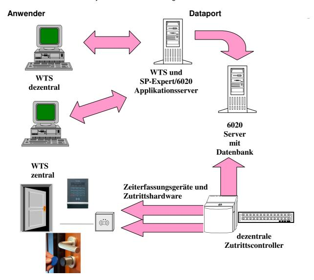
Die Identifikation in den Zeiterfassungs- und Zutrittsgeräten erfolgt über Chipkarten bzw. Schlüsselanhänger. Auf den Chipkarten ist lediglich eine Ausweisnummer gespeichert, die im System bei den Daten der jeweiligen Person hinterlegt ist. Als Zeiterfassungsgeräte sind Geräte der Firma Kaba Benzing, die im Zuge der Pilotierung zentral beschafft wurden, und der Firma Interflex, die aus einem Rahmenvertrag beschafft werden, im Einsatz.
